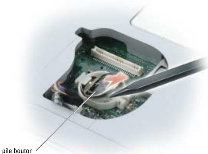
Pour mettre une nouvelle pile en place, insérez-la suivant un angle de 30 degrés sous la pince, le côté positif (identifié par le signe plus [+]) vers le haut, puis appuyez dessus pour la mettre en place.
