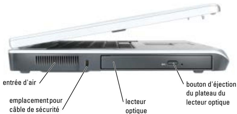
**ENTRÉE D'AIR** — L'ordinateur utilise des ventilateurs pour garantir la circulation de l'air à travers les entrées d'air et éviter tout risque de surchauffe.
