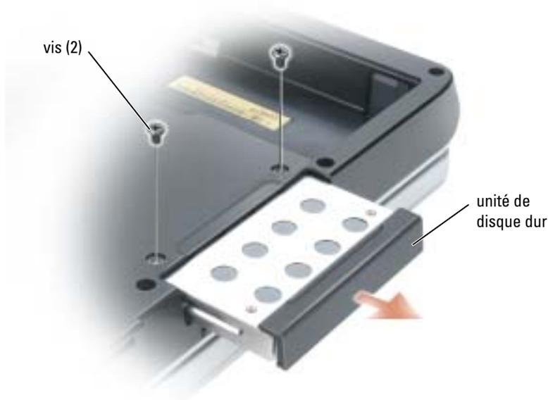
**AVIS** : Lorsque le disque dur n'est pas dans l'ordinateur, placez-le dans son emballage protecteur antistatique. Reportez-vous à la section «Protection contre les décharges électrostatiques» du *Guide d'information sur le produit*.
