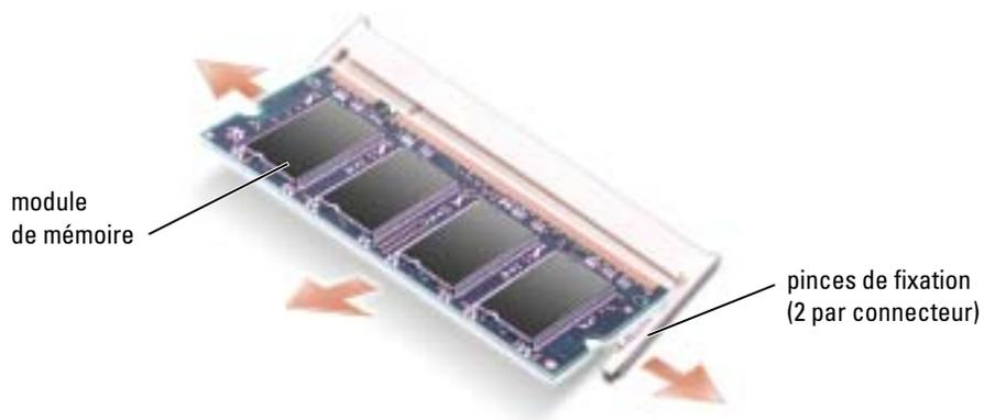
**AVIS** : Si vous devez installer des modules de mémoire dans deux connecteurs, installez un module de mémoire dans le connecteur libellé «DIMMA» avant d'en installer un dans le connecteur libellé «DIMMB». Insérez les modules de mémoire suivant un angle de 45 degrés pour éviter d'endommager le connecteur.
